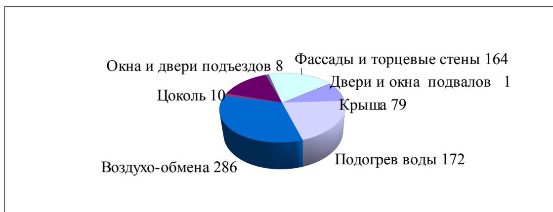
Рис. 8. Схема распределения теплопотерь в тепловом балансе
